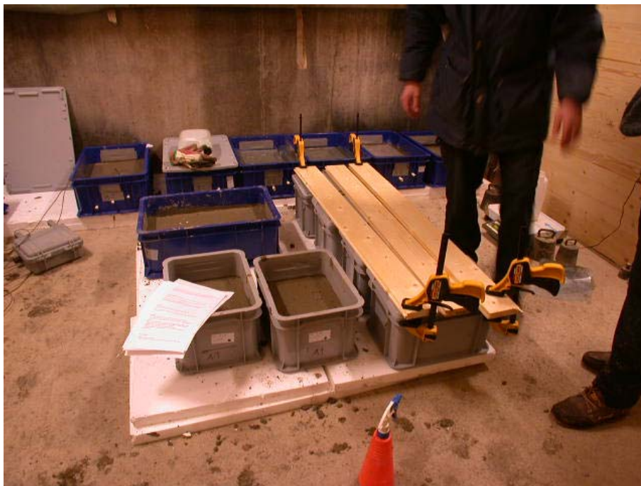
Figur 2 För att förhindra avdunstning förslöts backarna med lock som spändes fast
