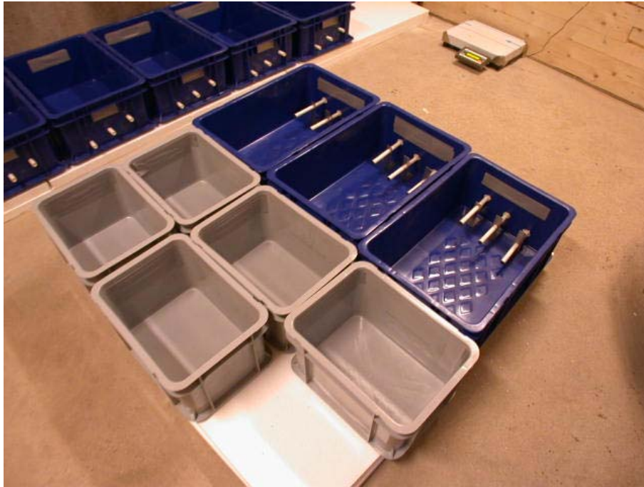
Figur 1 Stora och små plastbackar för gjutning av provkroppar
