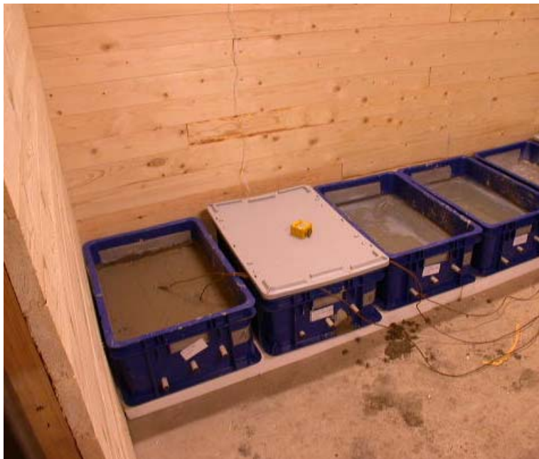
Figur 4 Temperatur och luftfuktighetsmätning med tinytaglogger under mätperioden
