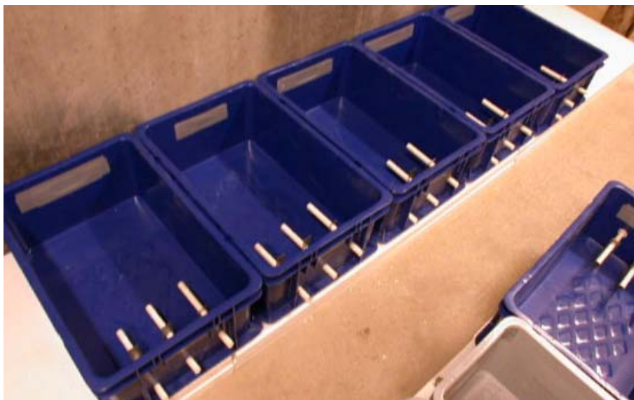
Figur 3 Givare monterades i rör som fästes horisontellt i backarnas sida på 20, 40 respektive 60% av gjuthöjden.
